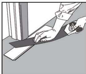
**Préparation :** Vérifiez toutes les lames et assurez-vous que la surface n'a pas été endommagée par le transport avant de commencer. Après avoir nettoyé le sous-plancher minutieusement, vous pouvez installer votre sous couche. Si le pare vapeur n'est pas intégré à la sous couche, vous pouvez l'installer en-dessous de la sous couche avec un chevauchement d'au moins 20 cm.
